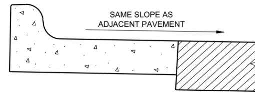
REVERSE SLOPE GUTTER<sup>6</sup>
