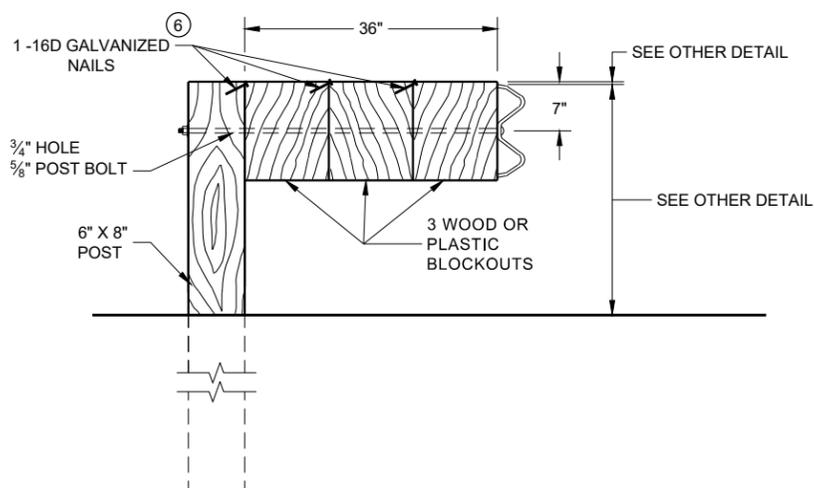
**DETAIL FOR 36" BLOCKOUT DEPTH**
