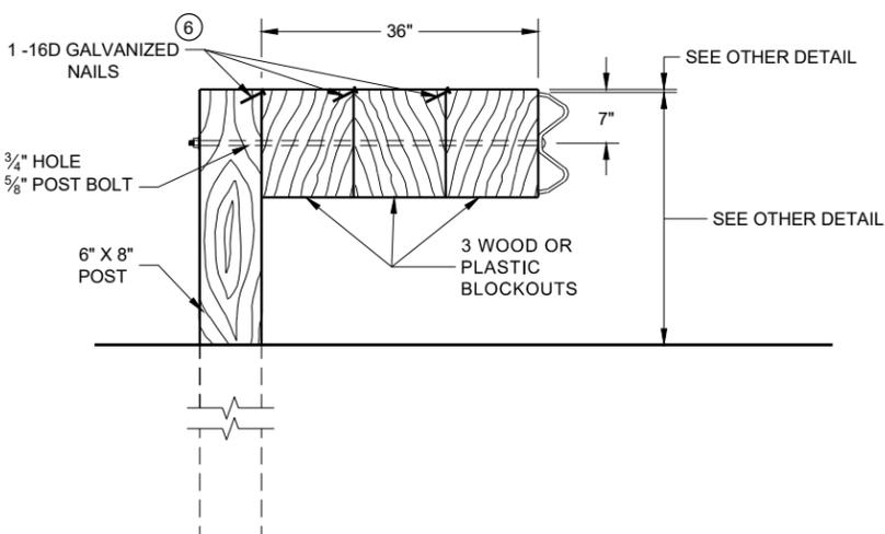
**DETAIL FOR 36" BLOCKOUT DEPTH**
