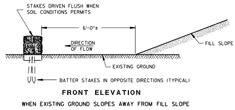
EROSION BALES FOR SHEET FLOW
