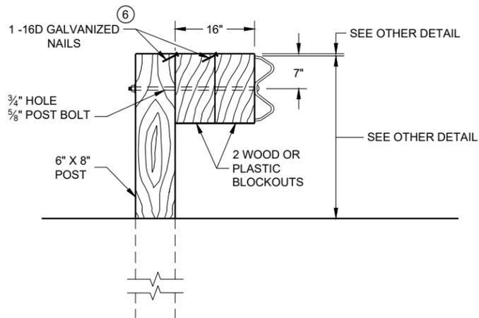
**DETAIL FOR 16" BLOCKOUT DEPTH**
