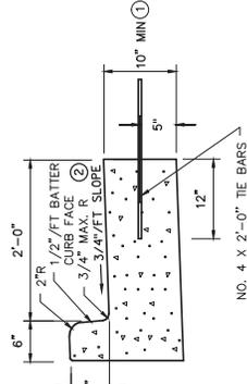
CONCRETE CURB & GUTTER
