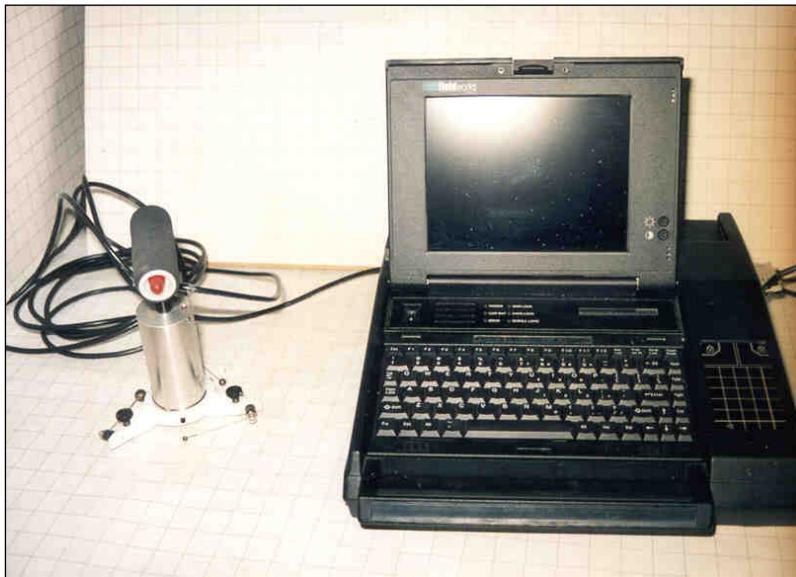
**Figure 5.12.1-1:** Impact Echo Test Unit.
