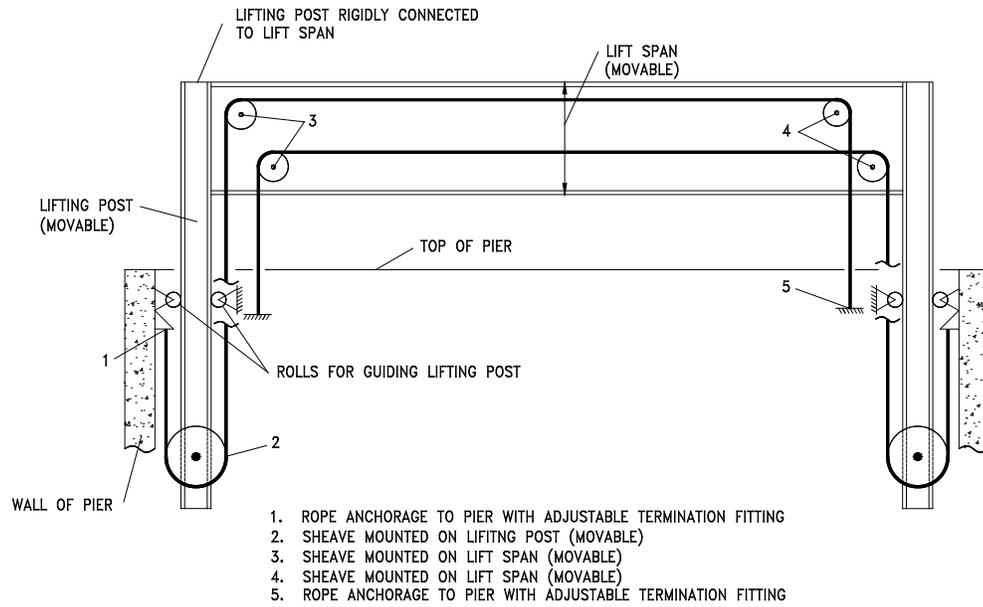
Figure 3.8.10.3-4: Sans-Drum Equalizing System.
