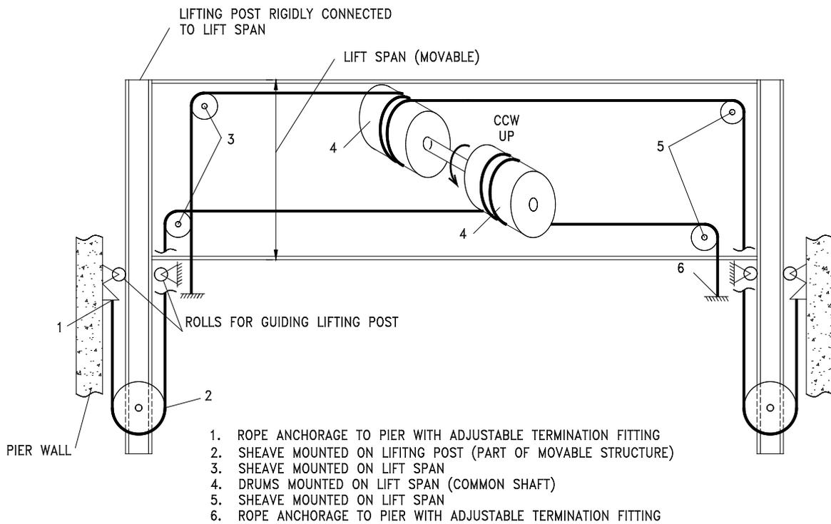
**Figure 3.8.10.3-1:** Moving-Drum Equalizing System.
