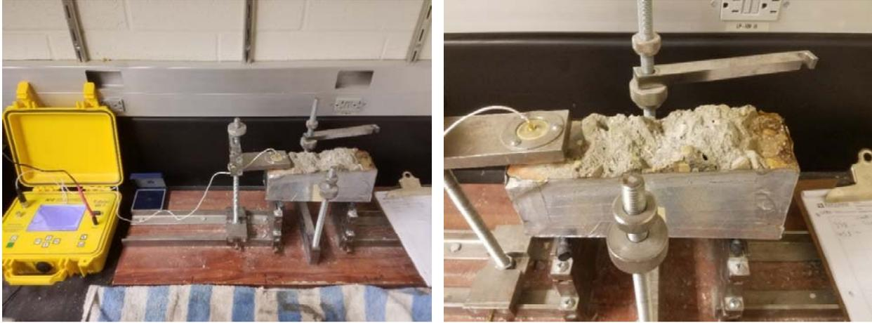
**Figure 3.4.2. Dynamic Modulus Testing**
