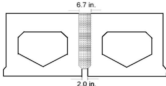
(d) Cast-in-place concrete shear key used in Japan
