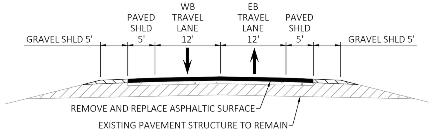
**WIS 19 FINISHED TYPICAL SECTION - MILL & OVERLAY**
