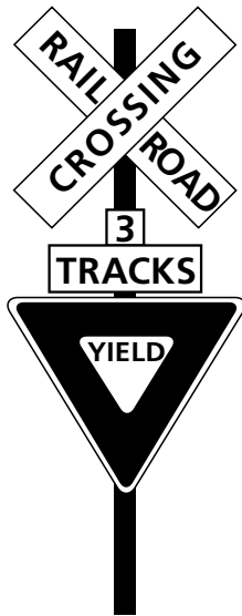
Figura 10-7: Vías Múltiples de Ferrocarril
